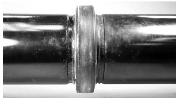
5. 배관 또는 밸브 결합: 배관 또는 밸브의 그루브 끝단 두께가 일치선이 되도록 맞춥니다. 다른 한쪽을 가스킷의 중간 돌출부에 닿을 때까지 가스킷에 삽입합니다. 주의: 가스킷의 어떠한 부분도 어느 한 쪽 배관의 그루브로 치우치지 않도록 해야 합니다.
