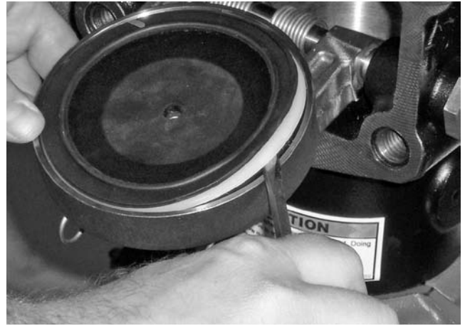
6. 클래퍼 씰 및 씰 링을 클래퍼에서 빼내십시오. 클래퍼 씰을 검사하십시오. 클래퍼 씰이 찢어지거나 마모된 경우 Victaulic이 공급한 새 클래퍼 씰로 교체하십시오. 클래퍼 씰 어셈블리를 새 것으로 교체할 경우, 여기서 7단계로 바로 넘어가십시오.
